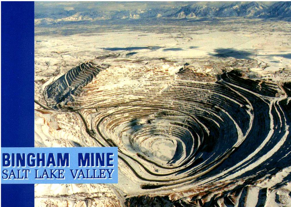
Es war wirklich gigantisch. Es ist ein riesiger Trichter in dem terrassenweise das Kupfererz abgebaut wird. Riesige LKWs fahren das Erz nach unten, und schütten es in die Mühlen. Nach dem Mahlen wird der Staub durch einen Tunnel zu den Aufbereitungsanlagen transportiert,
